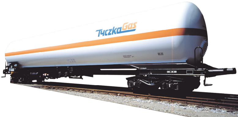
Abb. 21: Eisenbahnkessel- wagen mit oranem Streifen in der Höhe der Behälterachse
